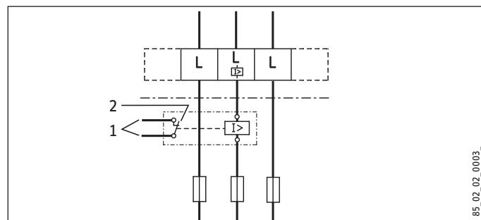
1 Stuurkabel voor het relais van het 2e toestel (bijv. elektrische accumulatorverwarming).
